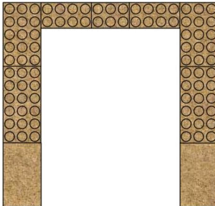
Le linteau (décaissement de 2cm) est directement posé sur les 2 briques plates en face avant.
